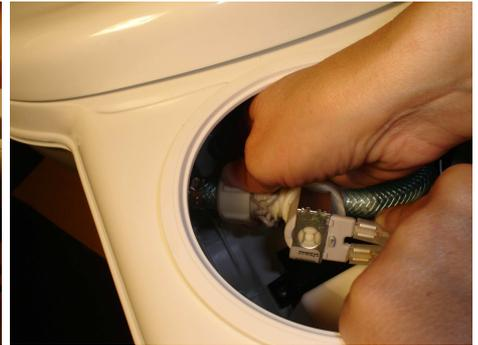
Entfernen Sie die Schlauchklemme vom Ventil
